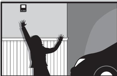
**Le bouton-poussoir monté au mur doit être hors de portée des enfants** à au moins 1,5 m (5 pi) de la surface d'appui la plus proche et à l'écart de toutes les pièces mobiles. Montez et utilisez le bouton là où vous pouvez clairement voir la porte de garage qui se ferme.
