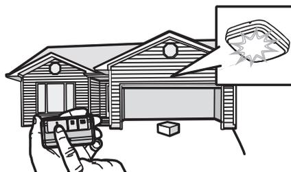
L'ouvre-porte de garage ne se fermera pas à l'aide d'une télécommande si le témoin DEL d'un des deux capteurs d'inversion est éteint (ce qui avertit que le détecteur est mal aligné ou obstrué).
